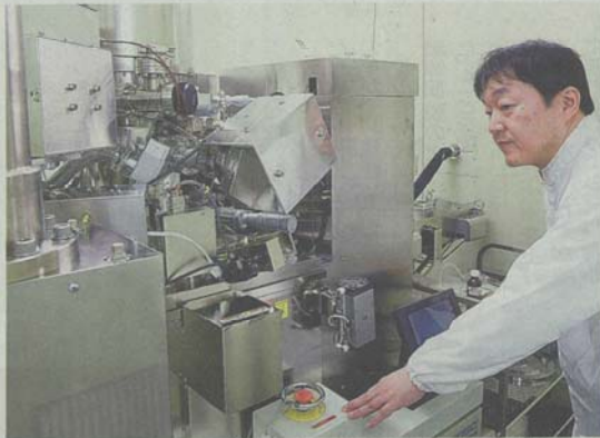
フォトリソグラフィの「型紙」をつくる電子ビーム露光装置。研究環境づくりに力を入れてきた
