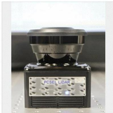
「2次元フォトニック結晶」レーザーを使い、対象までの距離を測定する装置
