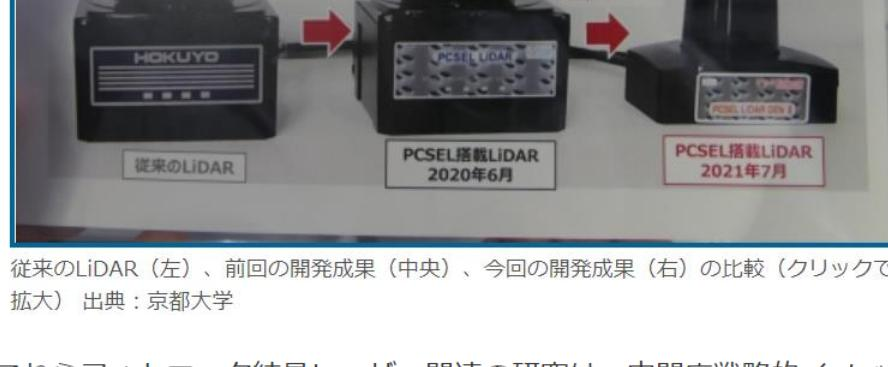
従来のLiDAR（左）、前回の開発成果（中央）、今回の開発成果（右）の比較（クリックで拡大） 出典：京都大学
