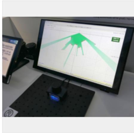
フォトニック結晶レーザーの採用で大幅な小型化を実現したLiDAR。後ろにあるディスプレイには、LiDAR前方の検知結果が示されている
